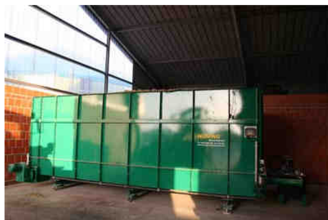
System do podawania substratów stałych (kontener, 68 m 3 ) z podajnikami ślimakowymi
