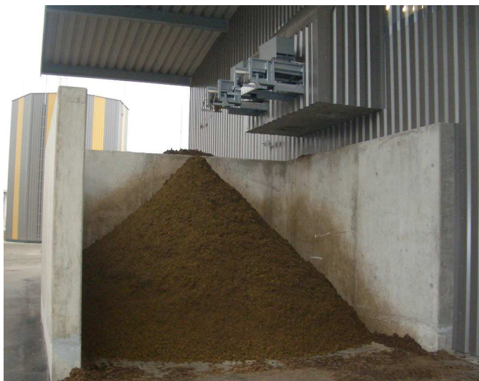
Fot 3 Odseparowana pozostałość pofermentacyjna o wartości 20 % suchej pozostałości (archiwum firmy LimnoTec)
