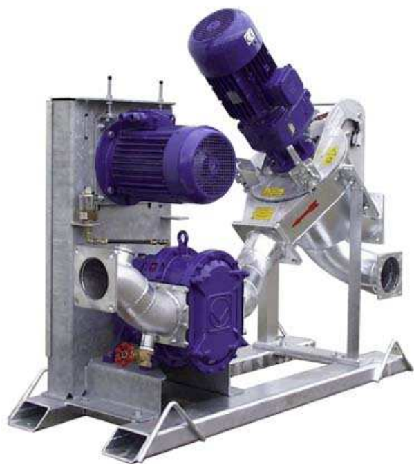
Rys. 2 Zespół BioCut do rozdrabniania i pompowania substratu firmy Vogelsang (autor Vogelsang).
